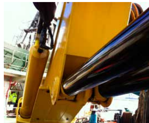
Kraan: Hydraulische cilinders voorzien van Lunac 2+ duplex na drie jaar in, in dit geval, bijzonder zware corrosieve belasting.
